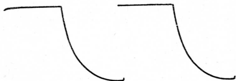
Przebieg napięcia na opornikach R_1 i R_4
