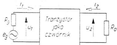
Rys. 1.6. Tranzystor z generatorem i obciążeniem
